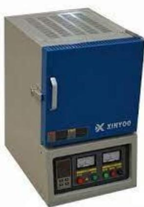
يستخدم هذا الجهاز عادة في معامل الكيمياء في حرق الرواسب.
