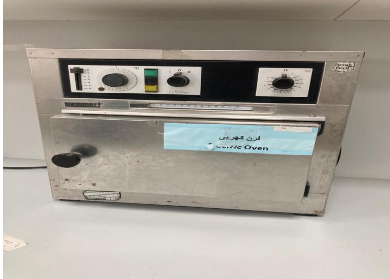
فرن الهواء الساخن (Hot air Oven) يستخدم لتعقيم الأدوات الزجاجية
