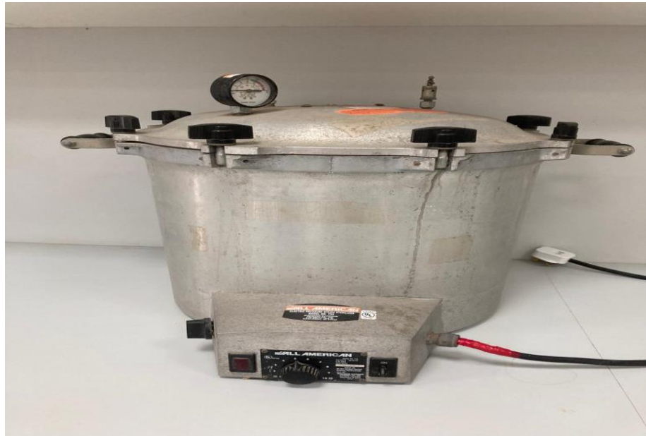
الأوتوكليف (Autoclave) يستخدم للتعقيم بالبخر تحت ضغط
