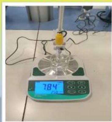
ويستخدم الجهاز لقياس الأس الهيدروجيني (pH) للمحاليل المختلفة
