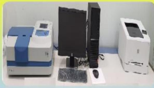
لحساب تركيز المادة عن طريق قياس طيف الامتصاص
