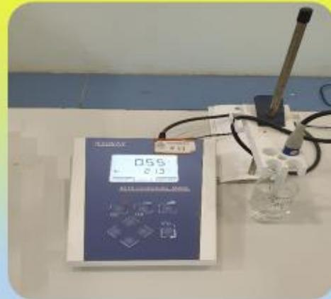
ويستخدم الجهاز لقياس التوصيلية الكهربائية
