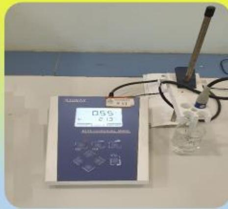
ويستخدم الجهاز لقياس التوصيلية الكهربائية
